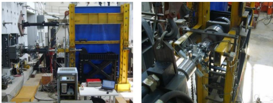
شکل ۵۰-۷ قرارگیری قاب حاوی میراگر LED تحت آزمایش [۴۵].
