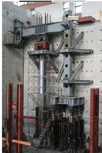
شکل ۷-۲۴ آزمایش چند محوری روی مهارندهای کمانش‌تاب، NCERR [۳۹].
