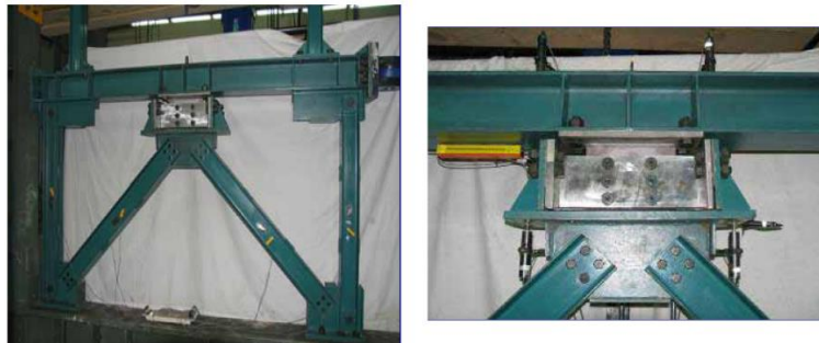
شکل ۶-۴۲ قاب حاوی میراگر FSBD تحت آزمایش [۲۴].
